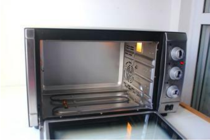
▲M形加热管，相当于4根直管相连，连接处形成弯曲，虽然在弯曲处温度会有所偏高，但对比整体面性加热影响不大，相比直管可以让烤箱内受热面积更大，烤色也更均匀。
